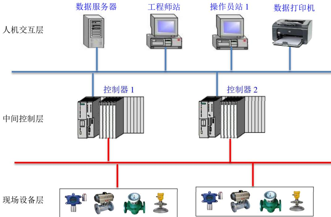
人机交互层：实现系统和用户之间数据交互的问题。用户可利用数据服务器、操作站等了解现场设备的具体数据内容、工作状态、故障状态等，同时可对现场设备的操作下达动作指令。和中间控制层的数据交互方式有局域网、因特网等；
